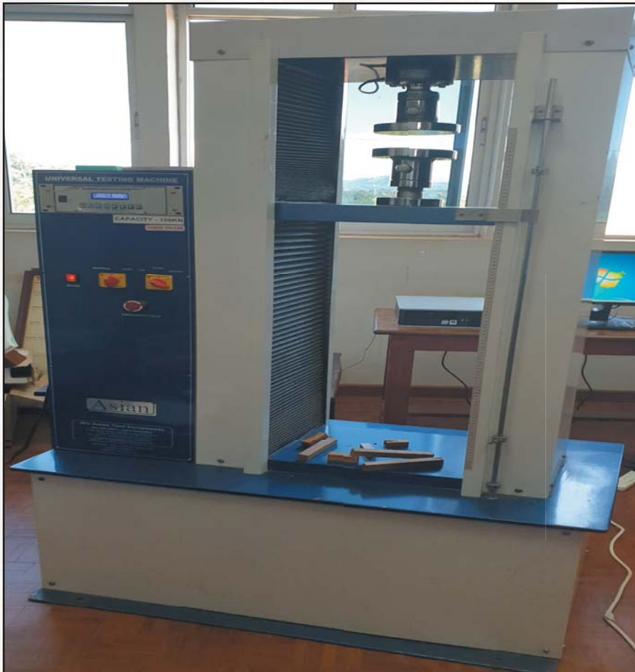
Kielelezo Na. 6: Mashine ya kupima ubora wa mbao iliyonunuliwa kwa kutumia ruzuku ya Mfuko.
